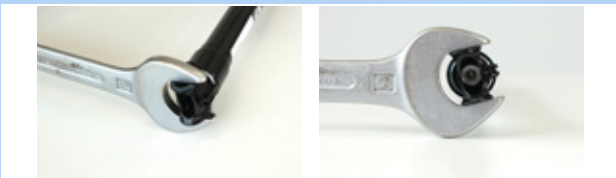
Afbeelding 149: Borgen tegen verdraaien
