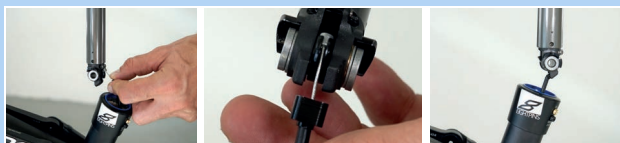
Abbildung 218: Sattelstütze aufhängen und einschieben
