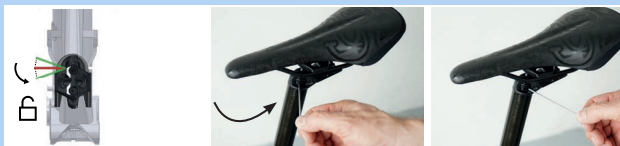
Abbildung 160: Höhenverstellungsbetätigung in „Geöffnete Stellung“ bringen
