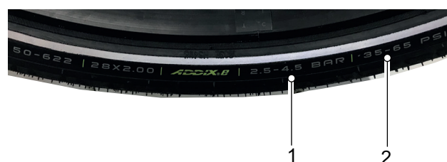
Abbildung 147: Fülldruck in bar (1) und psi (2)
