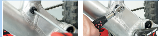
Abbildung 190: Postpin Achse befestigen
