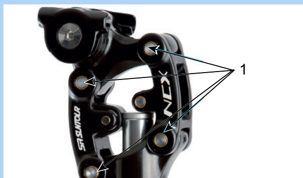
Abbildung 159: Schmierpunkte SR Suntour Feder-Sattelstütze
