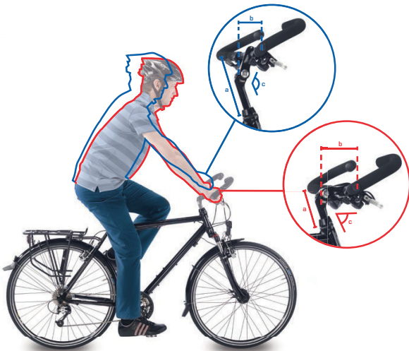
Abbildung 101: Citybike (blau) und Trekkingrad Position (rot) durch Winkeländerung
