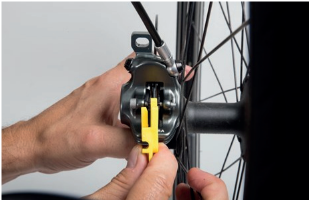
Abbildung 150: Bremsbelag im eingebauten Zustand mithilfe der Transportsicherung prüfen
