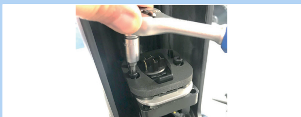
Abbildung 53: Akkuhalter Schrauben lösen
