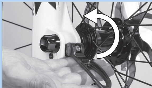
Abbildung 73: Schnellspannhebel in Pfeilrichtung drücken
