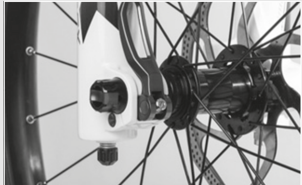
Afbeelding 35: Perfecte stand van de spanhendel
