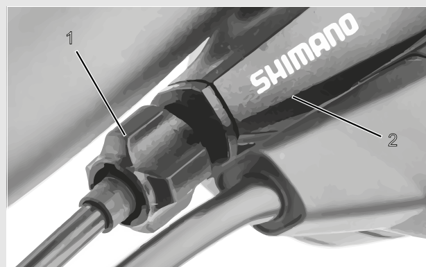
Afbeelding 73: Afstelwartel (1) van de versnelling met enkele bowdenkabelbediening en behuizing van de schakelhendel (2), voorbeeld
