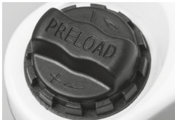
Afbeelding 58: Afstelwiel voor de negatieve veerweg op de kroon van de verende voorvork
