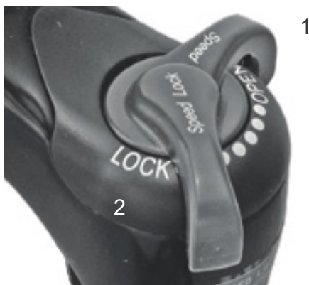
Illustration 55 : Dispositif de réglage de la compression Suntour avec les positions OPEN (1) et LOCK (2)
