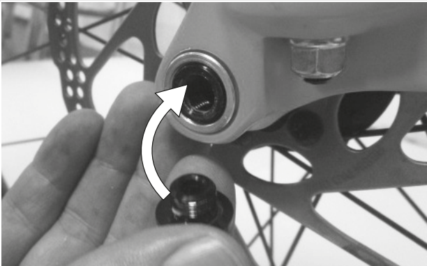
Afbeelding 27: Snelspanhendel in as schuiven
