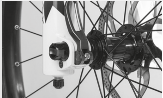
Afbeelding 84: Spankracht van de snelspanner afstellen
