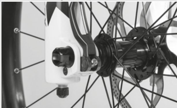
Illustration 36 : Position parfaite du levier de serrage
