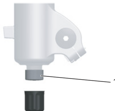
Illustration 61 : Dispositif de réglage de la détente FOX (1) sur la fourche
