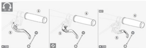
Afbeelding 19: Grijpafstand Magura schijfremhendel afstellen
