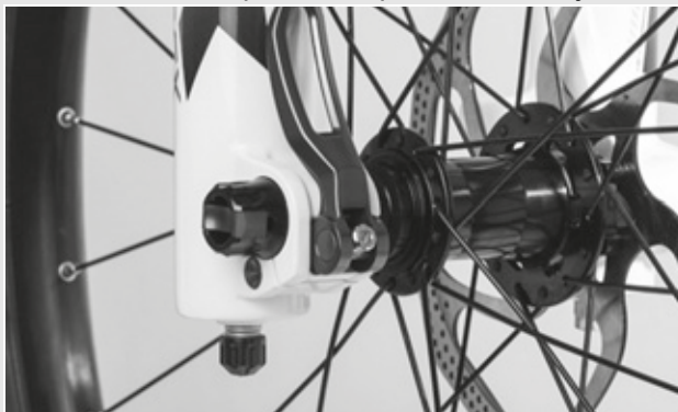
Afbeelding 33: Spankracht van de snelspanner afstellen
