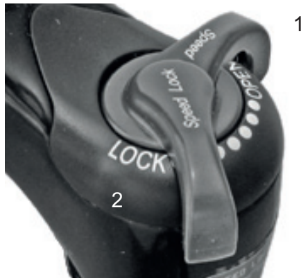
Illustration 46 : Dispositif de réglage de la compression Suntour avec les positions OPEN (1) et LOCK (2)
