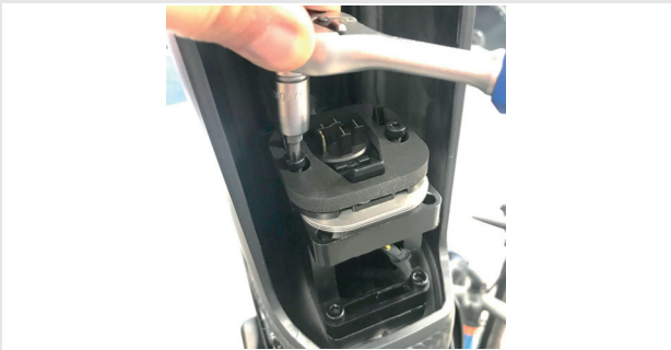
Abbildung 23: Akkuhalter Schrauben lösen
