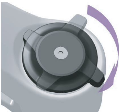
Abbildung 99: Druckstufeneinsteller härter einstellen
