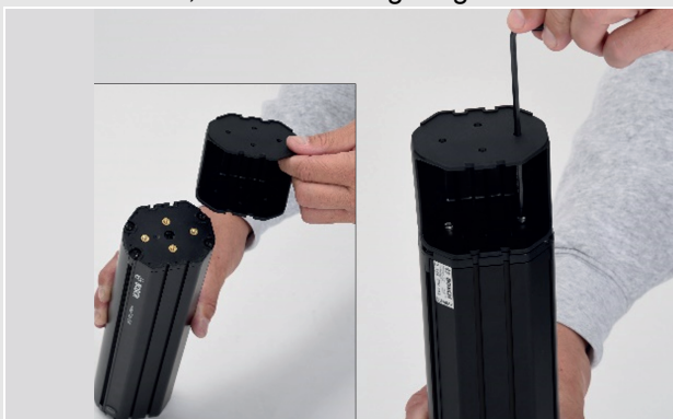
Abbildung 33: PowerTube EVerlängerung montieren
