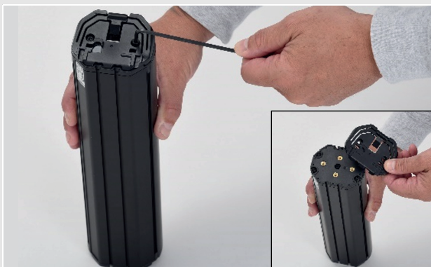
Abbildung 32: Demontage oberes Interface
